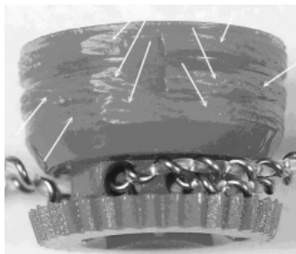
12 pav. Iš užrakto išimta ritė. Rodyklėmis nurodytos ritės pažeidimų vietos
