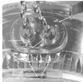
10 pav. Užrakto fragmentas. Rodyklėmis nurodytos užrakto korpuso pažeidimo vietos
