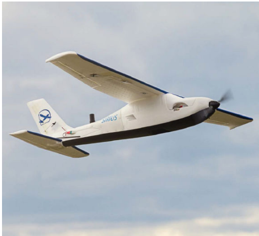
12 pav. Fiksuoto sparno bepilotė sistema „MaVinci. Sirius Pro“ ir sraigtasparnio tipo bepilotė sistema „Falcon 8 GeoEXPERT“.
